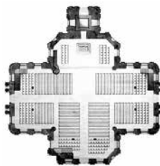
Der Grundriss entspricht etwa einem griechischen Kreuz; die Achsen sind 38,5 m und 24,2 m lang und jeweils 17 m breit.
